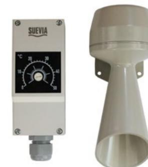
Alarme composée d'un avertisseur sonore pour circuit en boucle. L'installation se fait dans l'étable sur le circuit, séparément du réchauffeur. Si la température baisse à 5°C, l'alarme s'active et avertit d'une chute de température dans le système.
